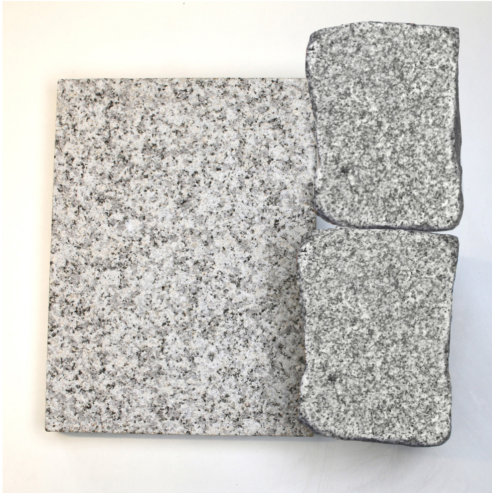
Innenstadt Mobilitätsstreifen, Granit, hell - Oberfläche sandgestrahlt, Kleinsteinpflaster Granit, hell
