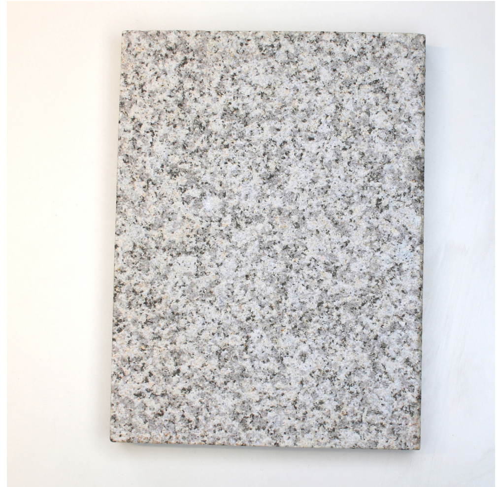
Granit, hell - Oberfläche sandgestrahlt
