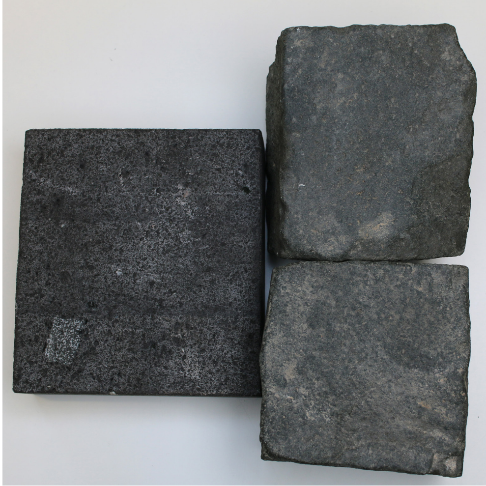
Innenstadt Mobilitätsstreifen Basaltlava - Oberfläche diamantgeschliffen Bestandspflaster Melaphyr Neupflaster Basalt
