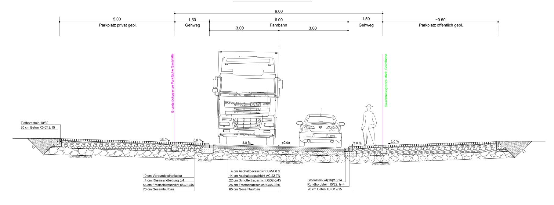
Ausbauquerschnitt B-B Achse1 Stat. 0+155.00
